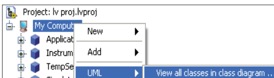
Figura 12 - VI di un lvlib visualizzati in UML
