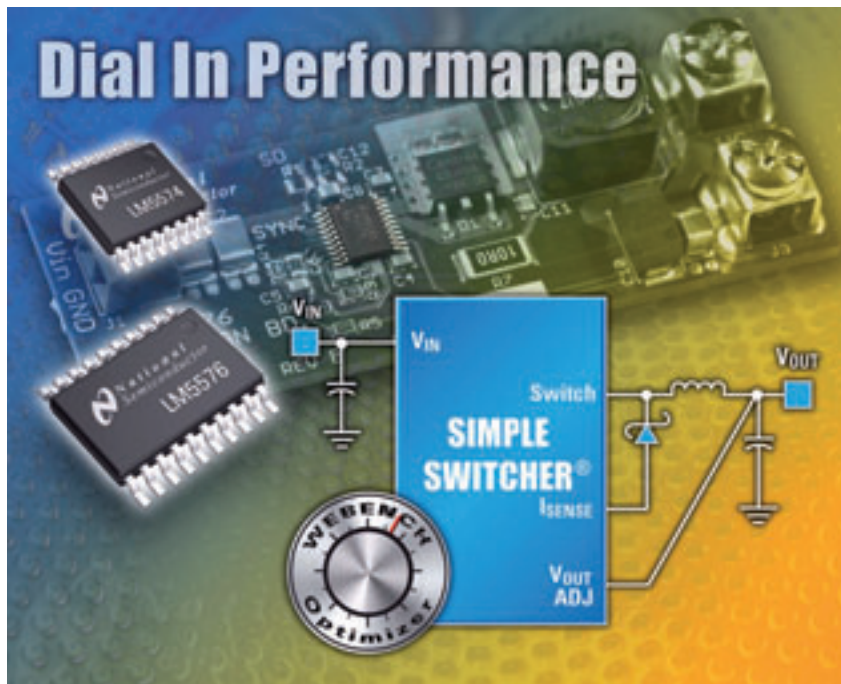
Fig. 1 - I primi regolatori che utilizzano la nuova tecnica ECM sono gli ultimi nati della serie Simple Switcher
