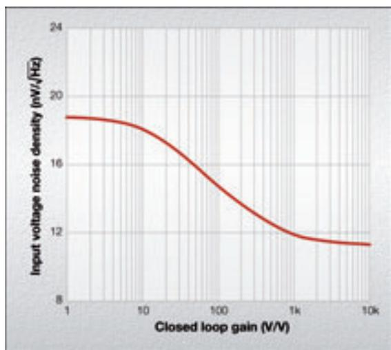
**Fig. 2 - Densità spettrale del rumore di tensione in ingresso in funzione del guadagno ad anello chiuso in continua nel caso di retroazioni puramente resistive**
