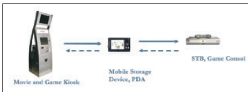
Fig. 2 – Una possibile applicazione delle comunicazioni wireless a 60 GHz è il download rapido dei filmati ad alta definizione
