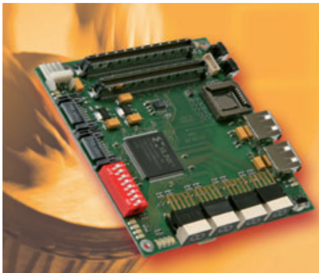
Fig. 2 - Scheda di debug per COM Express Type 2
