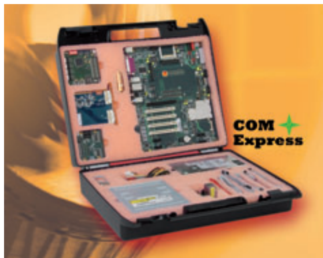
Fig. 3 - Lo starter kit permette di usufruire di funzioni di debug molto potenti
