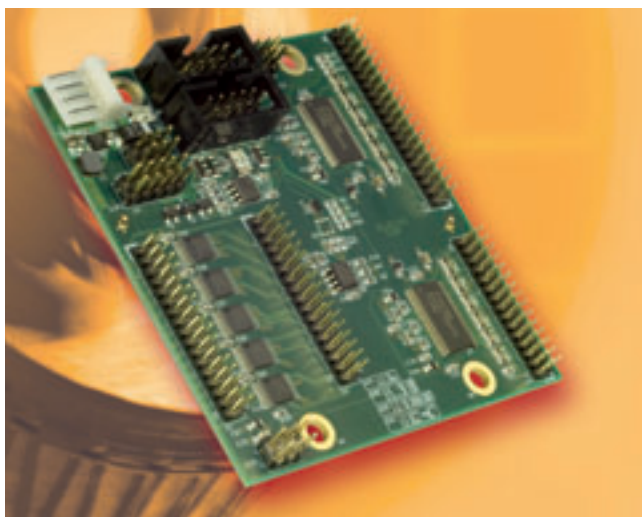
Fig. 4 - Conga-FPA1 è stata progettata per semplificare e accelerare l'avviamento di display Flat Panel
