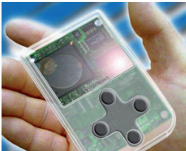
Fig. 2 - Il Computer-On-Module nanoETXexpress VX-8 ha le dimensioni di una carta di credito e può gestire una connessione PCI Express e due SerialATA
