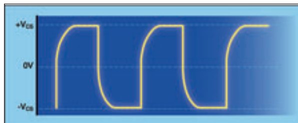
Fig. 8 – Andamento della forma d'onda di pilotaggio della lampada
