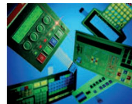
possono essere dotate di bordi, tasti, marchi o altri elementi in rilievo. Questa tecnica permette anche di realizzare tastiere Braille per persone non vedenti. Topflight produce anche tastiere a membrana a norma militare e ha ottenuto l'omologazione UL.
