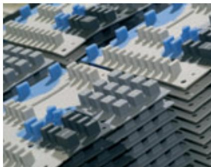
l'uso di copritastiere, che limitano la velocità e l'accuratezza della battitura dei tasti. Le nuove tastiere possono essere pulite senza dover essere immerse o disconnesse, con qualsiasi disinfettante per ospedali. Dotate di interfaccia USB e PS/2 sono compatibili con Windows XP e 2000. Il funzionamento è garantito per 100.000 attuazioni in un intervallo di temperature compreso fra 0 °C e 40 °C.
