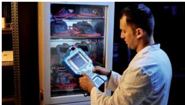
Fig. 3 - Il collaudo in camera climatica consente di verificare il funzionamento degli apparati anche in condizioni di temperature estreme
