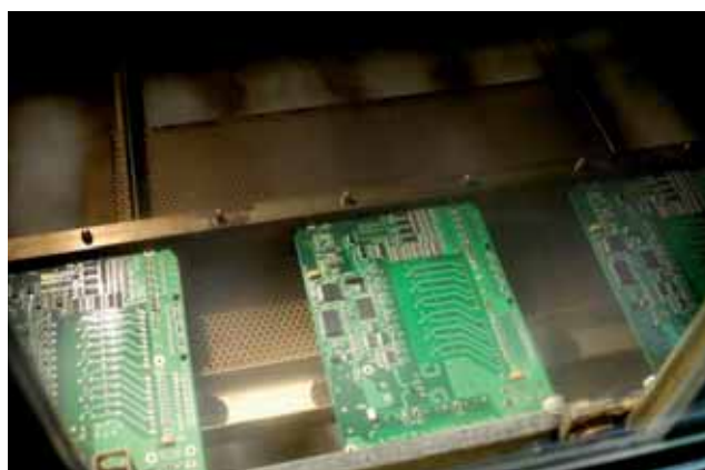
Fig. 1 - La saldatura in forno "vapor phase" consente la migliore qualità per il processo "lead free"
