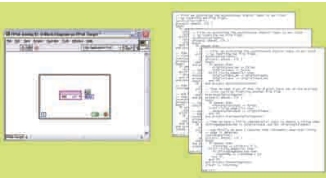
Fig. 1 - La progettazione grafica di sistemi assicura un livello di astrazione molto elevato. Nella figura viene raffigurato la chiamata di un I/O analogico effettuata con un linguaggio grafico di progettazione che consente di sintetizzare tre pagine di codice VHDL
