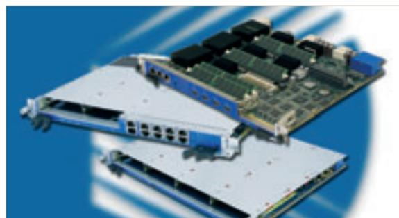
rier da 10 GbE Kontron AT8404 con quattro scomparti AdvancedMC. Tutti e tre sono stati progettati per essere conformi alle specifiche della Communications Platforms Trade Association (CP-TA). Con l'attuale matrice di switch a 10 Giga-bit, la larghezza di banda supportata può essere scalata a una capacità totale di 140 Gbit/s. Grazie a una simile capacità è possibile supportare più canali televisivi ad alta definizione (HDTV) e l'accesso a Internet a banda larga e al traffico voce.
