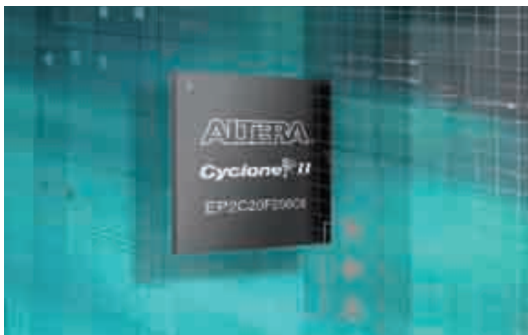
Fig. 1 - Un core IP SERCOS III, la logica di commutazione e un core di processore possono essere integrati in un singolo FPG della serie Cyclone II. Si tratta dunque di una soluzione economica e predisposta per le future evoluzioni per la realizzazione di nodi Ethernet in grado di supportare SERCOS III
