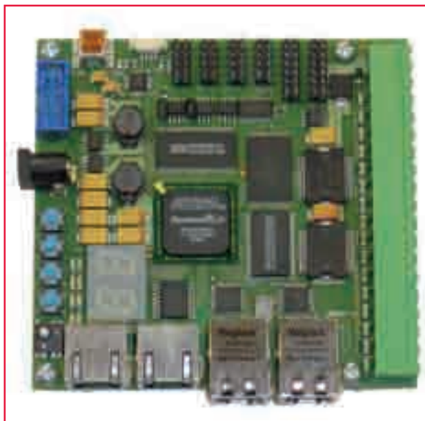
Fig. 2 - La scheda DBC2C20 disponibile presso EBV Elektronik è una piattaforma di valutazione che supporta numerosi standard per bus da campo. L'FPGA Cyclone II impiegata mette a disposizione risorse sufficienti per consentire agli sviluppatori di implementare su di esso un sistema completo per l'automazione di fabbrica
