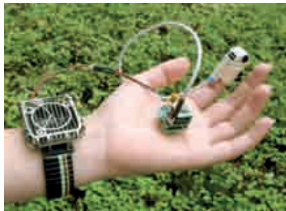
Fig. 3 – Il generatore termoelettrico che ha la forma di un orologio (a sinistra), il modulo con i circuiti elettronici di controllo (in mezzo) e lo strumento di misura indossato sul dito (a destra)
