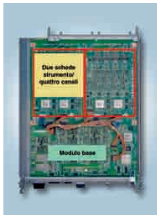
Fig. 2 - Il 16ch BBWGD, un modulo a segnali misti a 16 canali con elevato rapporto prezzo/prestazioni
