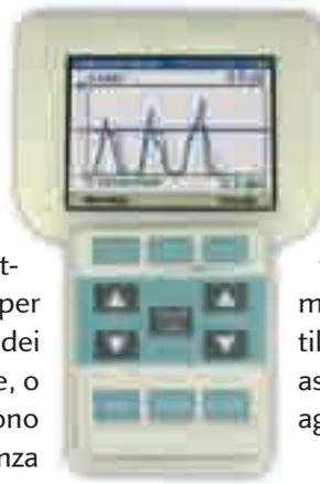
tattile anche se usate con guanti, come avviene di norma in ambito ospedaliero. La tecnologia PushGate usa una combinazione di un attuatore metallico e di un magnete permanente. Sfruttando l'attrazione magnetica al posto di cupole flessibili o delle molle, essa garantisce una sensazione tattile superiore senza effetti di degrado, assicurando una durata superiore rispetto agli switch convenzionali.
