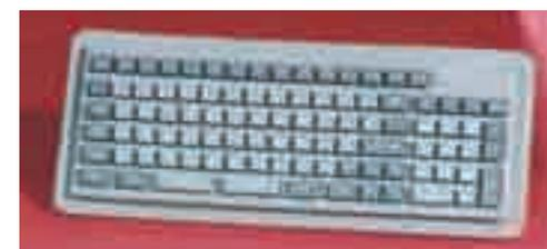
zionamento nell'intervallo di temperature compreso fra - 20 ÅãC e 80 ÅãC. Sono dotate di interfaccia PC di tipo IBM compatibile e sono disponibili anche in versioni custom dotate di touchpad e di trackball opzionali, con grado di protezione IP44 o IP65.
