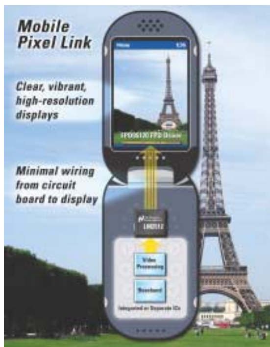
Fig. 3 - I prodotti della famiglia Mpl (Mobile Pixel Link) come il serializzatore LM 2512, permettono di ridurre il numero di connessioni e le interferenze Emi, oltre a dimezzare i consumi di potenza
