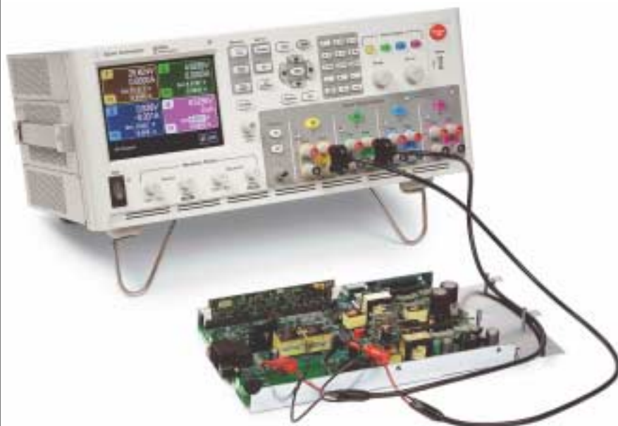
Fig. 1 - Fino a quattro alimentatori indipendenti, oscilloscopio e datalogger integrati costituiscono il nuovo analizzatore di alimentazione Agilent N6705A
