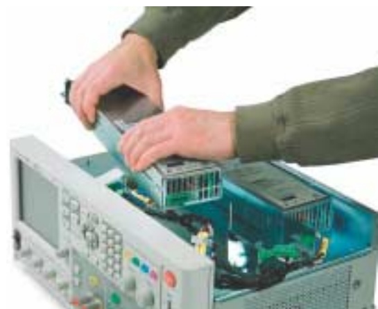
Fig. 3 - L'analizzatore ospita fino a quattro moduli di alimentazione facilmente intercambiabili a scelta tra i 21 modelli disponibili della serie N6700
