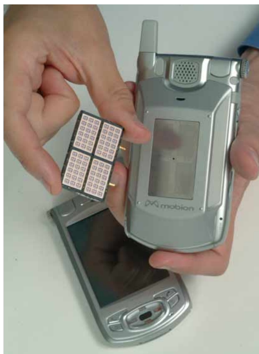
Fig. 5 - Le fuel cell sono ideali per applicazioni portatili quali cellulari e PDA (fonte: MTI Micro)
