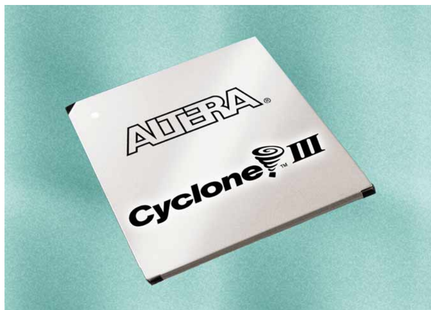
Cyclone III è la prima linea di Fpga a basso costo realizzato sfruttando un processo da 65 nm
