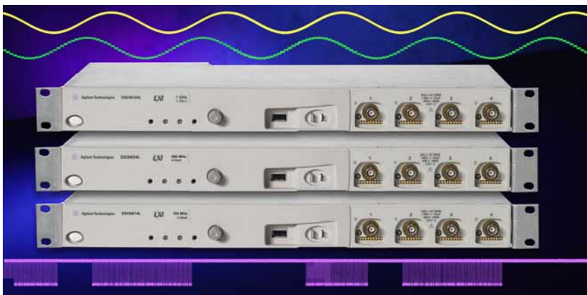
Fig. 5 - Un oscilloscopio Agilent 6000L a confronto con il suo equivalente da banco della serie 6000, il risparmio di spazio nella configurazione rack è evidente
