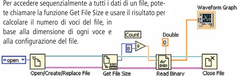
Fig. 4 - Lettura sequenziale di un intero file
