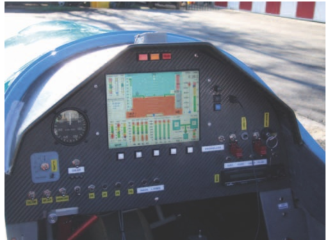
Fig. 5 - EFIS integrato sul velivolo Master - Millenium
