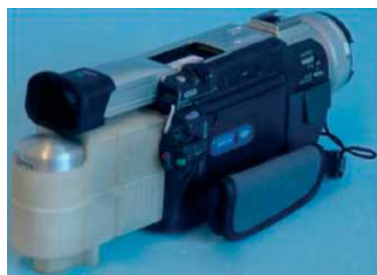
Fig. 3 - Un prototipo di fuel cell miniaturizzata per l'alimentazione di una videocamera (fonte: Istituto Fraunhofer)
