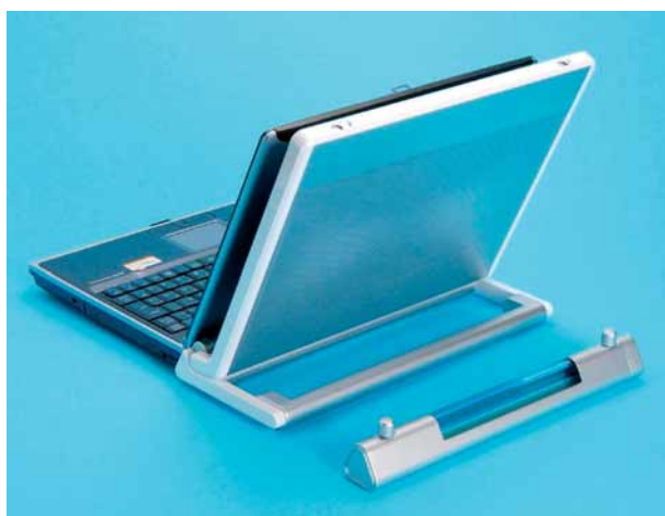
Fig. 2 - Prototipo di un laptop alimentato a fuel cell (fonte: Fujitsu)
