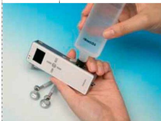
Fig. 4 - Celle al combustibile miniaturizzate sono in grado di aumentare considerevolmente la durata di funzionamento degli apparecchi elettronici portatili (fonte: Toshiba)
