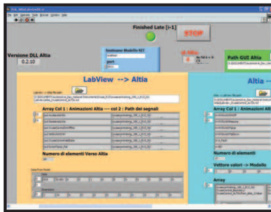
Fig. 3 - Il tool NI più semplice ed efficace per trasformare il modello realizzato in Simulink in un modello controllabile da LabVIEW è il SIT, Simulation Interface Toolkit
