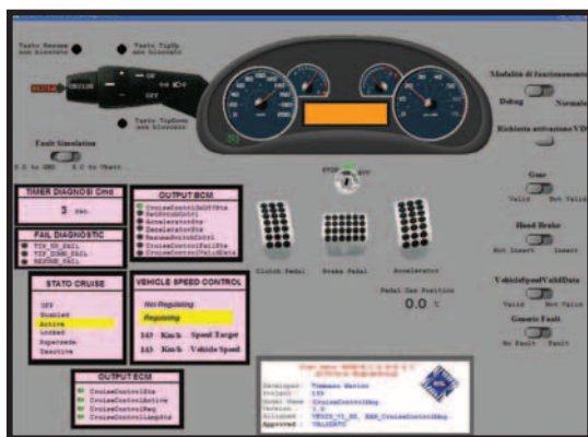
Fig. 1 - Cruscotto con i comandi del Cruise Control
