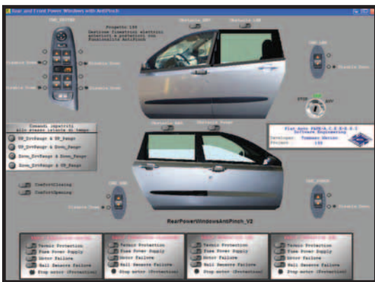
Fig. 2 - Controlli delle portiere per la gestione del sistema alza cristalli
