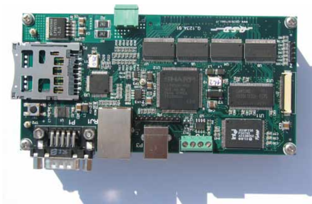
Fig. 2 - La scheda Q_123A equipaggiata con ARM SHARP LH79525 permette di realizzare con semplicità piccole automazioni
