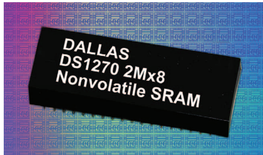
Fig. 1 - Modulo NVSRAM in pacchetto DIP di prima generazione
