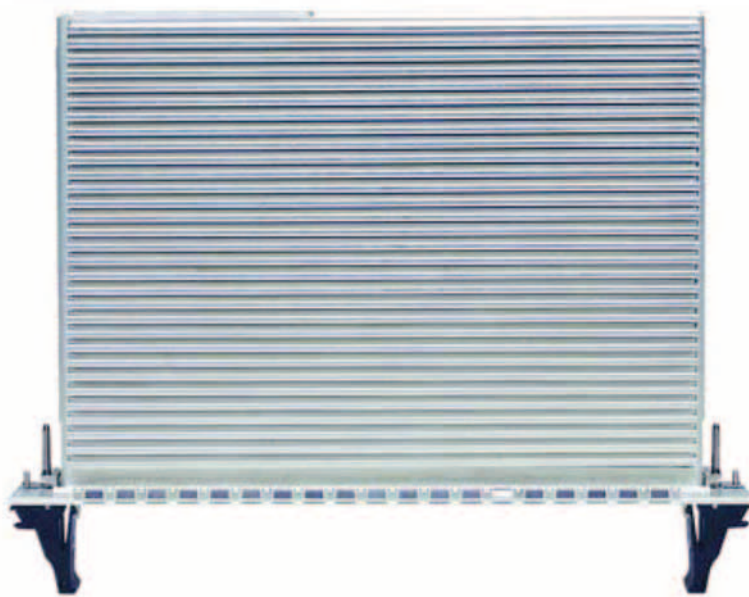
Fig. 3 - In formato CompactPCI, il VMICPCI-PS351 Hot Swap offre tre uscite in tensione di 3,3 V, 5 V e \pm 12 V e può lavorare a temperatura ambiente senza bisogno di ventilazione d'aria forzata
