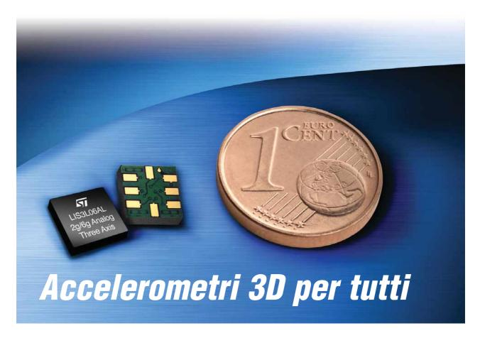
Le tecnologie MEMS sviluppate nella sede ST di Agrate Brianza banno permesso di realizzare accelerometri tridimensionali a bassissimo costo che promettono di rivoluzionare le interfacce utente di molte applicazioni elettroniche
