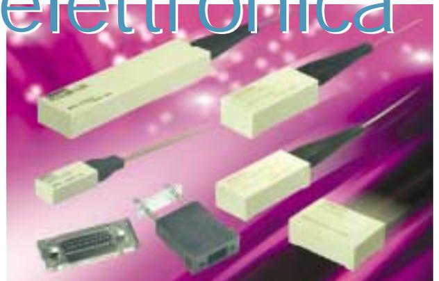
**F**airchild Semiconductor ha recentemente introdotto il nuovo dispositivo FOD2200, un optoaccoppiatore caratterizzato da una bassa corrente di ingresso e da un'elevata tensione di isolamento (5 kV rms) lungo un intervallo di tensioni di alimentazione compreso fra 4.5 V e 20 V. L'elevata reiezione di modo comune (CMR), pari a 1kV/μs, e l'uscita con isteresi consentono al dispositivo di offrire le massime prestazioni in applicazioni ad alta velocità in ambienti industriali ostili.
