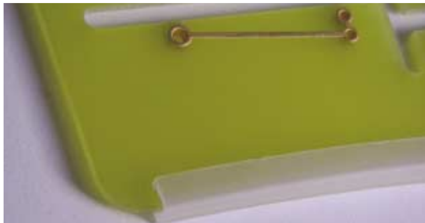
Fig. 2 - Il copri spigolo, evita distacchi dell'elastomero
