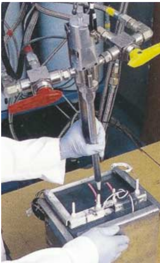
Fig. 1 - L'ugello statico per la mescolatura e inserimento gomma siliconica
