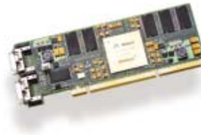
Fig. 2 - La scheda IB4X-LPCIX-2 è capace di sfruttare pienamente la velocità di trasmissione disponibile sulle connessioni InfiniBand
