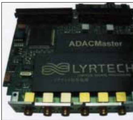
Fig. 3 - La piattaforma di prototipazione C67x DSP/FPGA di Lyrtech è stata scelta da The MathWorks per uno studio sulla Software Defined Radio
