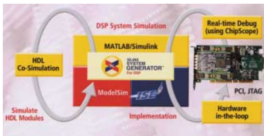
Fig. 1 - Xilinx System Generator serve per realizzare processori DSP con prestazioni personalizzate e modificabili usando gli FPGA
