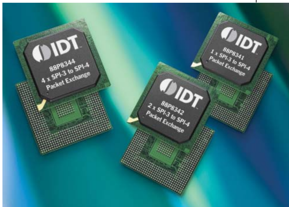
Fig. 1 - I componenti Packet-Exchange di IDT permettono di gestire da uno a tre flussi formattati secondo lo standard SPI-3 e di instradarli verso un'interfaccia a velocità più elevata di tipo SPI-4
