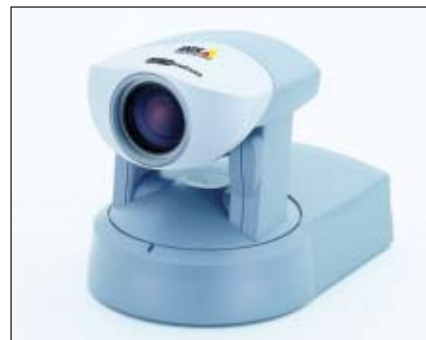
Le cosiddette 'network camera', utilizzate nella videosorveglianza, integrano un Web server basato su Linux embedded e non necessitano di collegamento a PC
