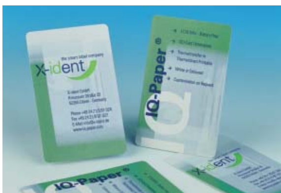
Le etichette di X-ident technology funzionano su una radio frequenza di 13,56 MHz
