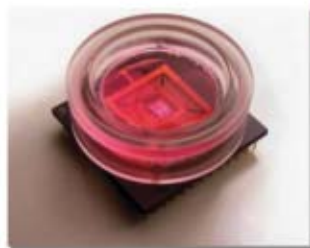
Fig. 6 – Il Neuro-Chip di Infineon Technologies integra oltre 16.000 sensori in uno spazio di 1 mm 2 (fonte Infineon Technologies)
