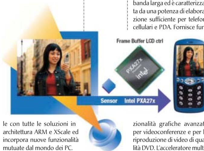
le con tutte le soluzioni in architettura ARM e XScale ed incorpora nuove funzionalità mutuare dal mondo dei PC. I processori PXA27x, che verranno offerti in diverse configurazioni con velocità di clock da 312 fino a 624 MHz e con un massimo di 64MB di memoria, sono i primi dispositivi in architettura XScale ad includere la tecnologia Intel Wireless MMX, per l'accelerazione multimediale ad alte prestazioni. Essi integrano
