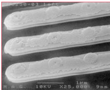
Fig. 3 - Il profilo superficiale di un dispositivo QuickLogic è identico per tutte le connessioni, che siano o meno programmate
