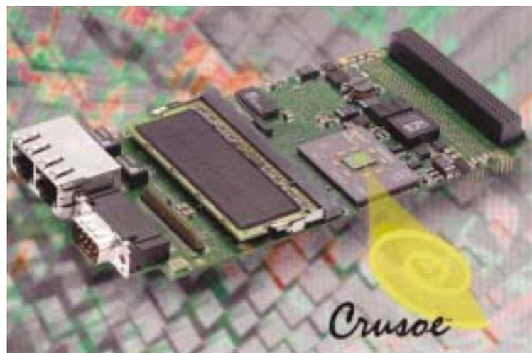
Em05 Embedded System Module (Esm) è una soluzione perfettamente x86 compatibile dotata di processore Crusoe realizzata da Men Mikro Elektronik
