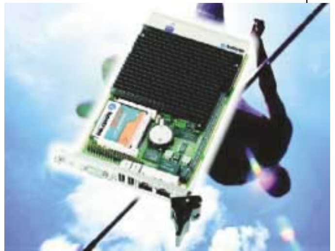
Fig. 2 - Un vantaggio delle schede basate su Pentium M è la possibilità di assicurare le funzioni di un sistema basato su processore Intel Pentium 4 con un consumo considerevolmente inferiore
