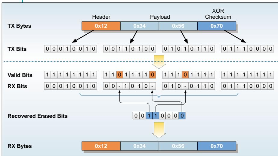
Fig. 2 - BER (Bit Error Correction): mediante l'esecuzione di un'operazione logica di Xor su ciascun byte di dati e la trasmissione della relativa somma di controllo come ultimo byte di ciascun pacchetto, i sistemi WirelessUSB possono ricevere dati senza errori, anche a frequenze caratterizzate da elevati livelli di interferenza
