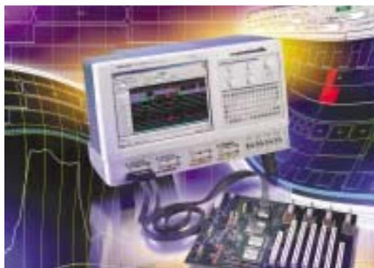
Inoltre, tramite l'utilizzo di un'unica sonda, è possibile eseguire contemporaneamente acquisizione di stati logici e timing.
