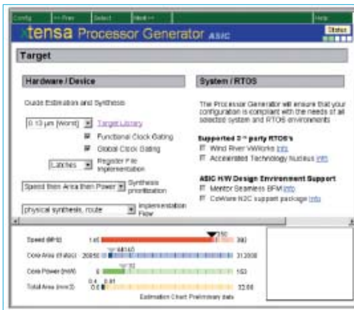
Fig. 4 - Xtensa Processor Generator è un'interfaccia grafica di facile utilizzo attraverso la quale il progettista può selezionare i parametri per un'ampia gamma di opzioni di configurazione
