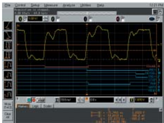
Fig. 1 - Le linee di indirizzamento sono monitorate tramite le 8 tracce digitali inferiori
