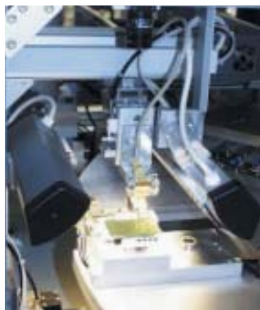
Fig. 2 e 3 - Il controllo dei display da parte del sistema P400 avviene mentre sono posizionati su un tavolo circolare
