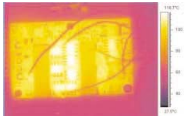
Fig. 3 - Esempio di un'immagine a raggi infrarossi ottenuta dalle rilevazioni termiche su un modulo di potenza
