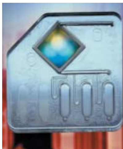
Fig. 2 - Flow-Thru Chip è un mini-laboratorio su silicio. In una superficie di soli 1 centimetro quadrato il chip può analizzare simultaneamente la reazione di un massimo di 400 geni conosciuti
