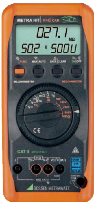
misura per la verifica della sicurezza elettrica di auto elettriche e ibride: METRA HIT|H+E CAR, composto da un multimetro palmare multifunzione comprensivo di misura di resistenza d'isolamento fino a 1000V e da una serie di accessori necessari all'esecuzione delle verifiche in conformità alle direttive UN ECE R100.
