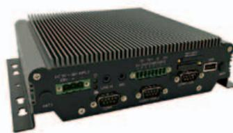
Il nuovo VBOX-3130 può funzionare in condizioni atmosferiche avverse e supporta una temperatura operativa che va da -40°C a +70°C e una temperatura di stoccaggio da -40°C a +80°C.
