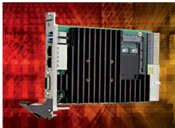
Il pannello frontale della scheda F26L ospita una porta VGA, due interfacce Gigabit Ethernet e due USB 3.0. L'uso di schede di espansione permette di aggiungere un'ampia gamma di UART, quattro porte USB, una porta SATA e un'interfaccia audio ad alta definizione (HD). Quattro interfacce USB 2.0, quattro PCI Express x1 e due Gigabit Ethernet sono accessibili attraverso il connettore di I/O J2 ubicato sulla parte posteriore.
