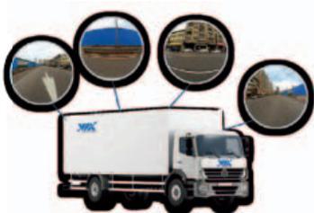
Il kit comprende quattro fotocamere FOV-190, un monitor touch 720P P-Cap da 7" con un supporto fisico VESA e un modem 4G e tecnologia GPS per il tracciamento da remoto.
