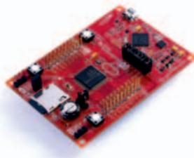
di FRAM e prestazioni 40 volte superiori rispetto ad altre MCU a bassa potenza, in grado di offrire agli sviluppatori funzionalità di elaborazione del segnale digitale (DSP) con un nuovo acceleratore integrato a bassa energia (LEA) facile da usare; MCU MSP430FR2111, le prime a includere memorie FRAM in un piccolo package QFN da 3x3 mm, per l'aggiornamento dei progetti a 8 bit con la gamma ampliata di MCU TI Value Line.
