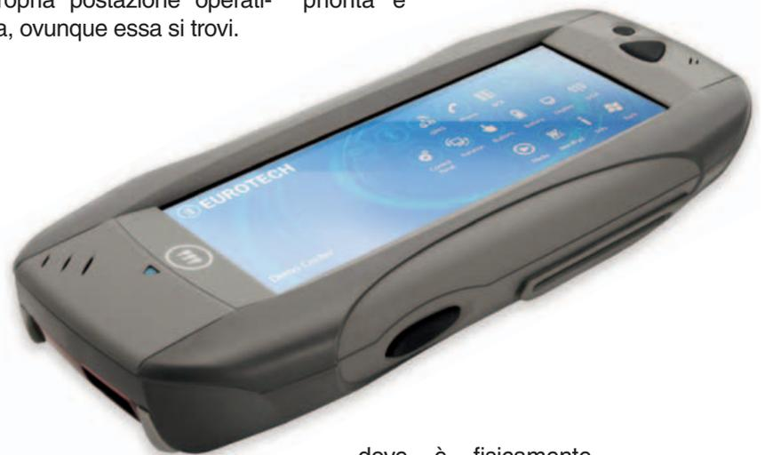
HRC-3100 di Eurotech è un rugged handheld computer dalla forma ergonomica adatto a essere tenuto nel palmo della mano. Il design piccolo, compatto e leggero, oltre al grado di protezione elevato (IP54), rendono HRC-3100 adatto a essere utilizzato in un'ampia gamma di applicazioni come punti vendita, magazzini, servizi sul campo, catene produttive o di fornitura.
