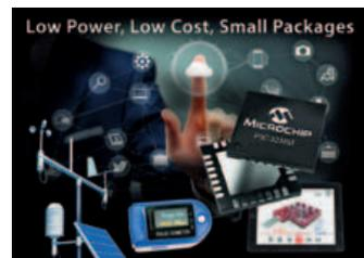
Per applicazioni che richiedono basso consumo e una prolungata vita delle batterie, PIC32MM ha una modalità sleep di soli 500 nA. Applicazioni con restrizioni sulle dimensioni beneficeranno delle opzioni del piccolo package 4x4 mm. I dispositivi PIC32MM possono contare su core independent peripheral quali un Configurable Logic Cells (CLC) e Multiple-output Capture Compare PWM (MCCP) che consentono di realizzare applicazioni di controllo motori BLDC sensorless.
